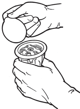
Εικόνα 11. Αφαίρεση του καλύμματος του εσωτερικού δίσκου
