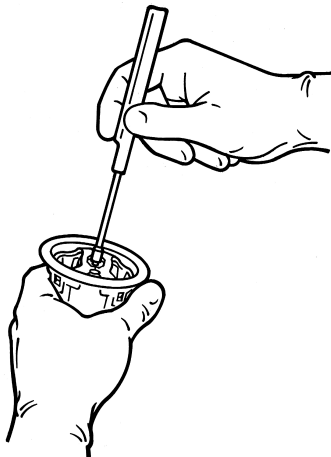
Figur 12. Sæt holderhåndtaget fast i klapholderen
