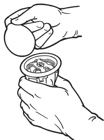
Фигура 11. Свалете капака на вътрешната табла
