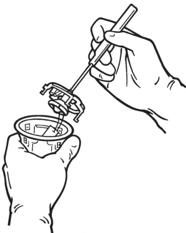
Figura 13. Sacar la válvula y el casquillo de la bandeja interior
