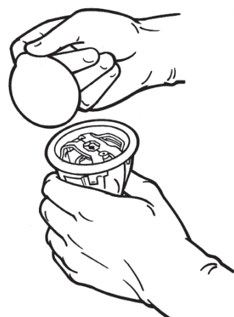
Figur 11. Fjern dekselet på det indre brettet
