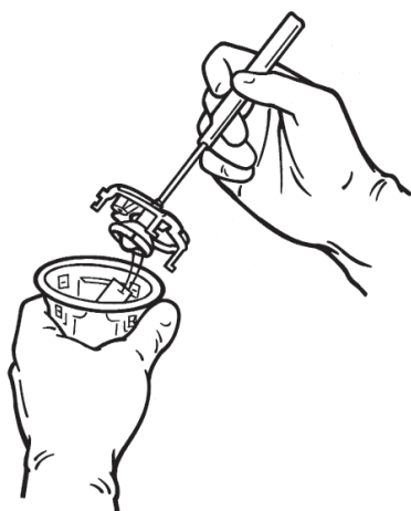
Figur 13. Tag klappen og kraven ud af den indvendige bakke.
