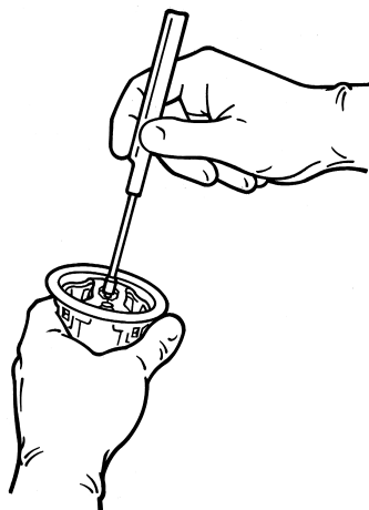
Bild 12. För in hållarhandtaget i klaffhållaren
