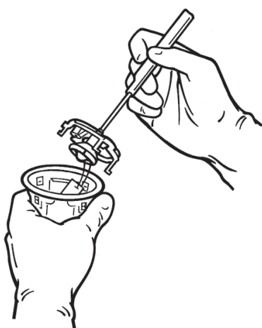
Slika 13. Vađenje zaliska i prstena iz unutrašnje podloge
