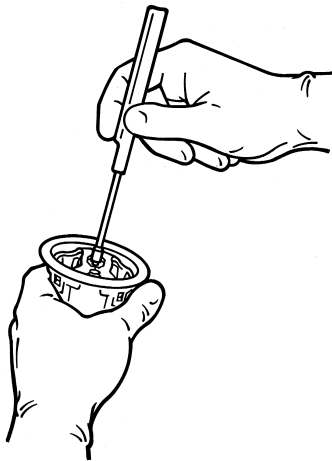
Figuur 12. Het houderhandvat in de klephouder plaatsen
