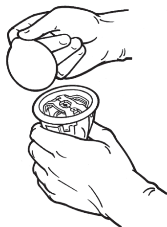
Rysunek 11. Usuwanie pokrywy tacki wewnętrznej
