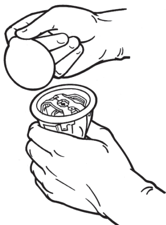
Obr. 11. Odstraňte kryt vnitřního zásobníku
