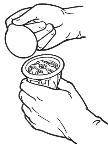
Figuur 11. De afdekking van de binnenste tray verwijderen
