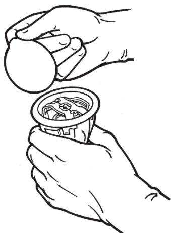
Obr. 11. Odstránenie krytu vnútorného zásobníka
