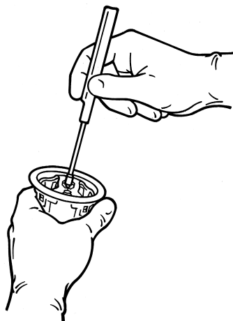
Joonis 12. Sisestage hoidiku käepide klapihoidikusse.
