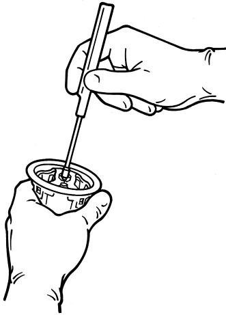
Abbildung 12. Setzen Sie den Haltegriff in den Klappenhalter ein
