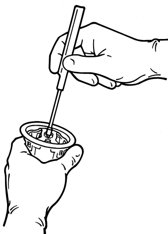
Obr. 12. Vložte rukojeť držáku do držáku chlopně
