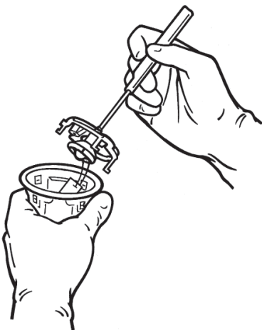
Εικόνα 13. Αφαίρεση της βαλβίδας και του κολάρου από τον εσωτερικό δίσκο
