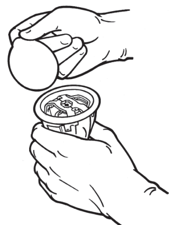
Figura 11. Remover a cobertura do tabuleiro interior
