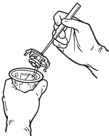
Slika 13. Z notranjega pladnja odstranite zaklopko in manšeto
