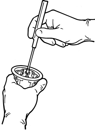
Şekil 12. Kapak tutucuya tutucu kolu yerleştirin
