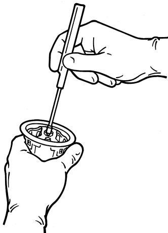
Εικόνα 11. Εισαγωγή της λαβής συγκρατητήρα στον συγκρατητήρα βαλβίδας
