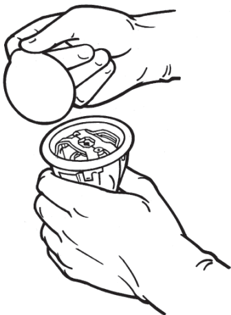
10 pav. Pašalinkite vidinio dėklo dangtelį
