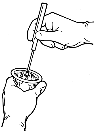
ábra. 11. Illessze a tartónyelet a billentyűtartóba
