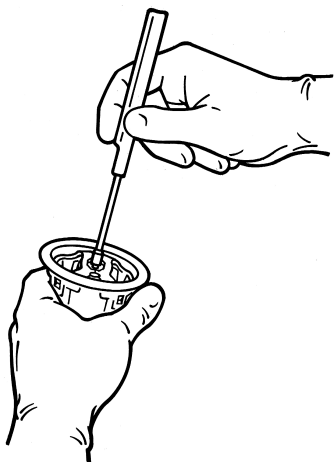
Obr. 12. Vyjměte chlopeň a límeček z vnitřního zásobníku.
