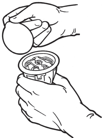
Figura 10. Rimuovere il coperchio del vassoio interno
