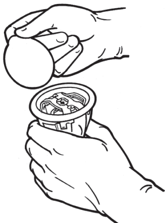
Figuur 10. De afdekking van de binnenste verpakking verwijderen
