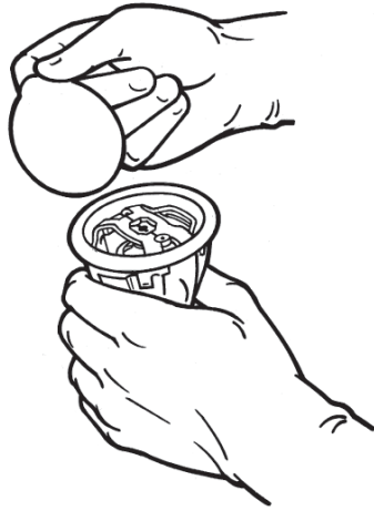
Εικόνα 10. Αφαίρεση του καλύμματος του εσωτερικού δίσκου
