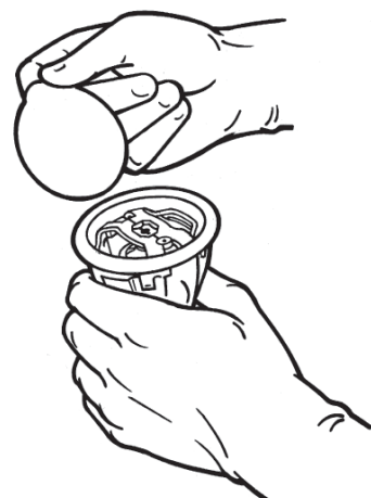
Slika 10. Uklanjanje poklopca unutrašnje podloge
