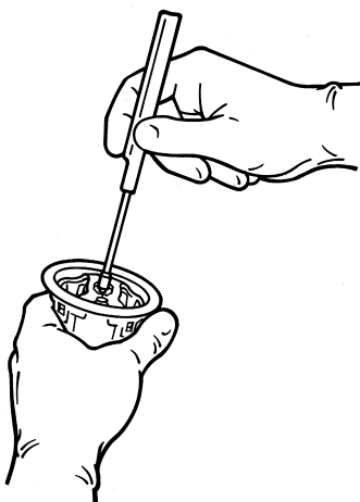
Figura 11. Inserir a pega do suporte no suporte da válvula
