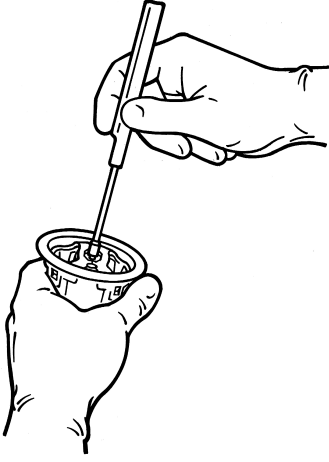
Şekil 11. Kapak tutucuya tutucu kolu yerleştirin
