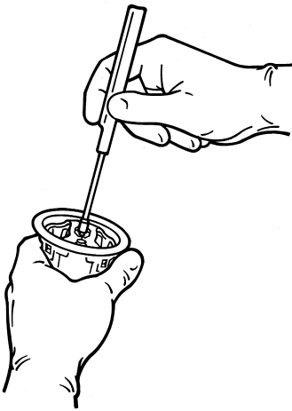
Figure 11. Insertion du manche dans le porte-valve
