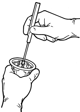
Figura 11. Inserire il manipoLO nel supporto della valvola
