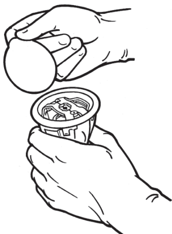
Фигура 10. Свалете капака на вътрешната табла
