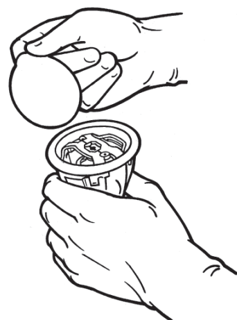
Bild 10. Ta bort det inre trågets lock
