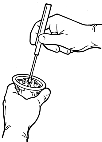
Abbildung 11. Einsetzen des Haltegriffs in den Klappenhalter
