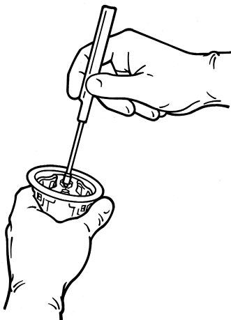
Figuur 11. Het houderhandvat in de klephouder plaatsen
