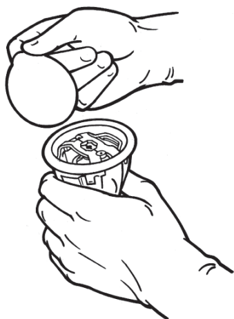
Obr. 10. Odstraňte kryt vnitřního zásobníku
