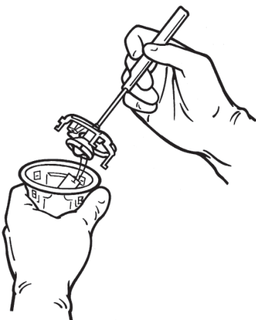
Figura 12. Estrarre la valvola ed il colletto dal vassoio interno
