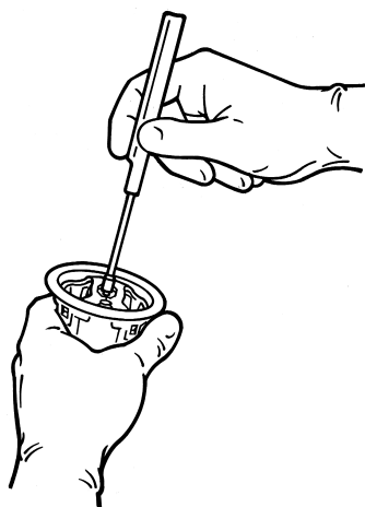
Figur 11. Sæt holderhåndtaget fast i klapholderen
